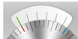
825 – halkaisijan säätötarkkuus 0.002 mm työkalun asteikolla. Täysi kierros (360°) muuttaa halkaisijaa 0.5 mm. Hienoavarruspään koko säätöalue on 15 mm.
